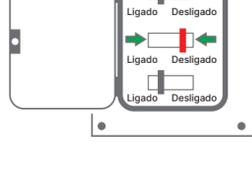
**Passo 2** Remova o interruptor e verifique a existência de Fio NEUTRO na caixa de passagem. No caso de não haver Fio NEUTRO deverá fazer a passagem do mesmo até o ponto onde será instalado o dispositivo
