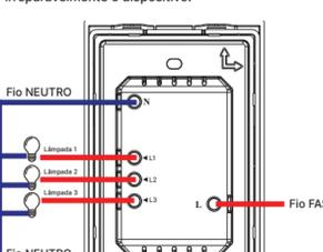
**Passo 5** Ligando o circuito. Ligar o disjuntor do circuito. Após 15 segundos pressione liga/desliga do dispositivo algumas vezes para confirmar o correto funcionamento do dispositivo.
