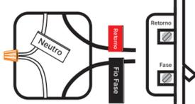
**Passo 4** Instale o interruptor TB26. Faça a ligação conforme o diagrama abaixo. Caso necessite fazer emenda ou derivação utilize conectores apropriados. Verifique cuidadosamente se a ligação está correta. Após terminar a conexão dos fios fixe o interruptor com os parafusos correspondentes e fixe o espelho. ATENÇÃO: a ligação incorreta pode danificar irreparavelmente o dispositivo.
